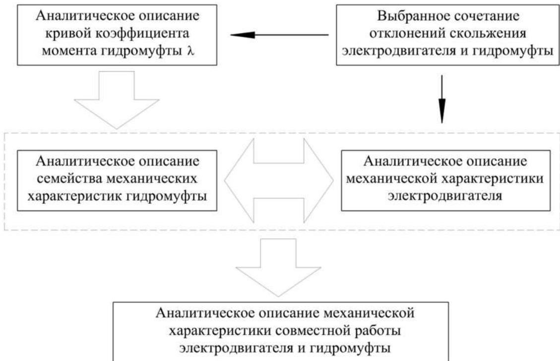
**Рисунок 2.7 – Структурная схема математической модели совместной работы электродвигателей и гидромуфт**
