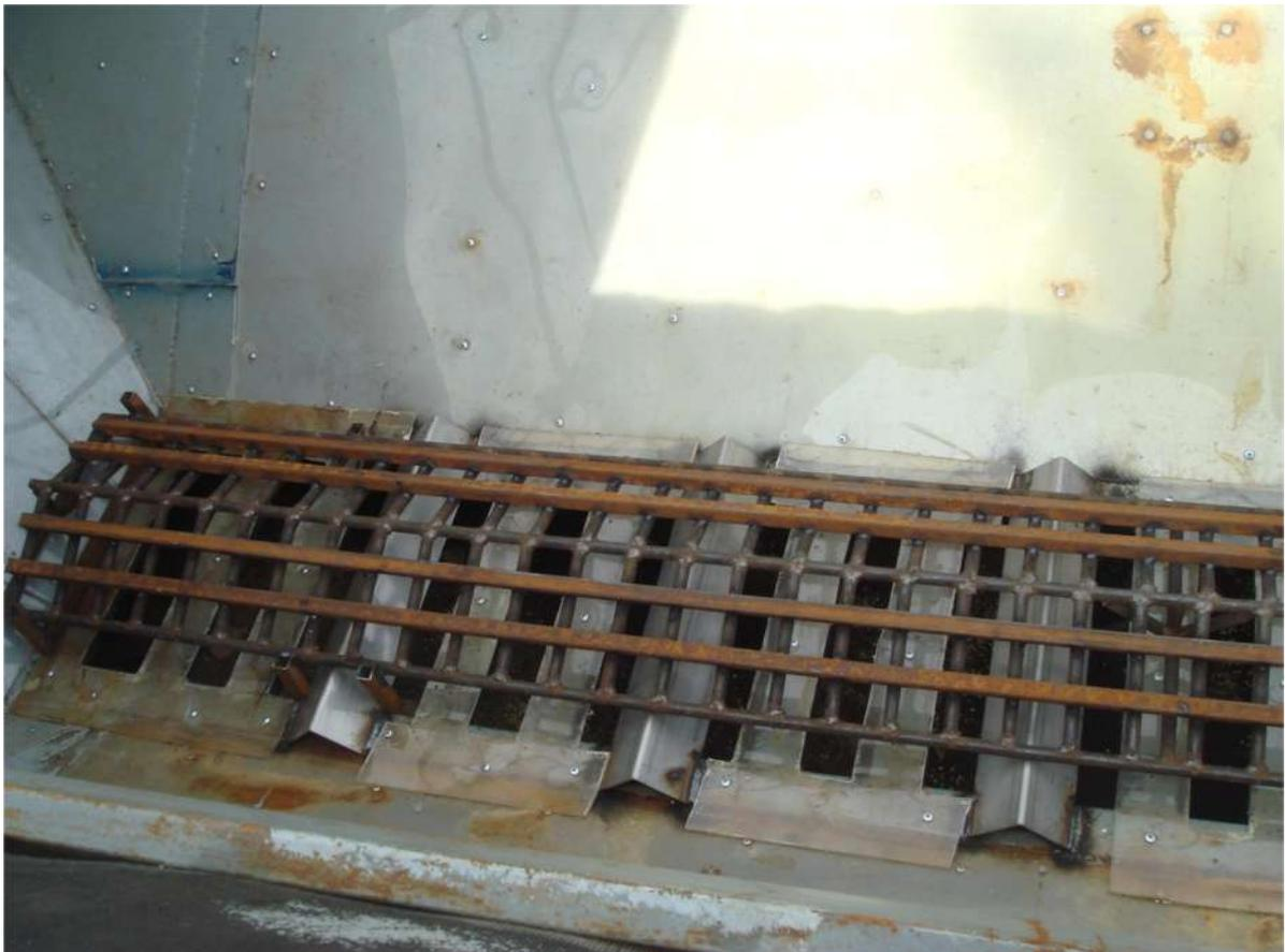
Рисунок 4.4 – Закрепление дополнительной решетки бункера
