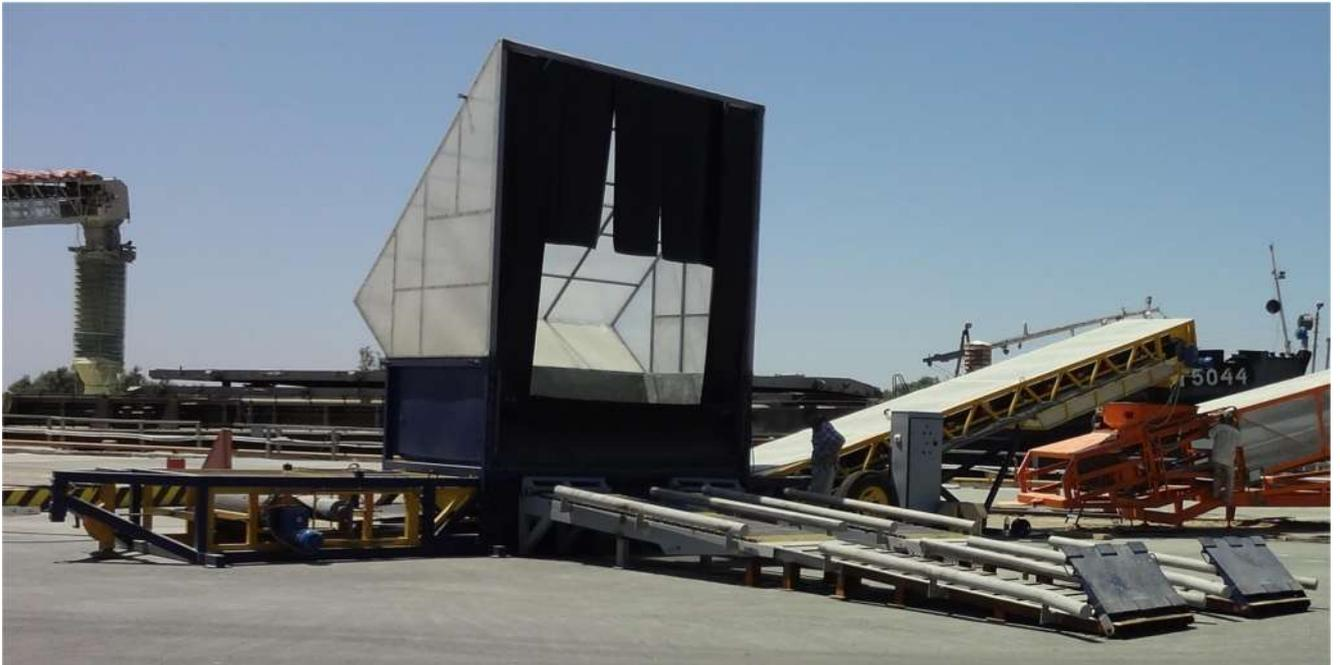
**Рисунок 4.1 – Приемный ленточный передвижной бункер-питатель СПКБ 12-4**
