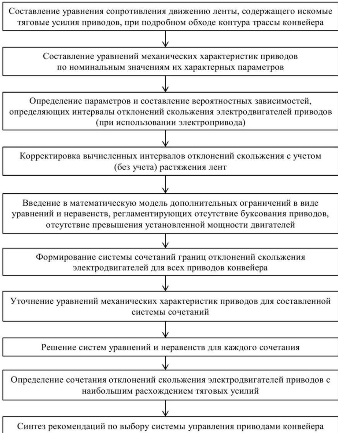
**Рисунок 2.6 – Последовательность построения вероятностной математической модели распределения тяговых усилий внутри систем приводов ленточных конвейеров**
