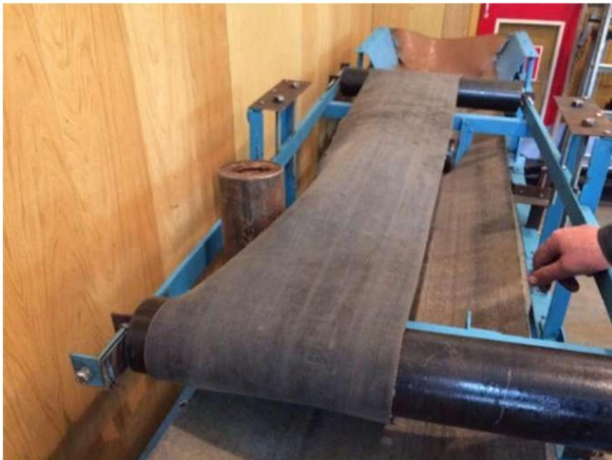
**Рисунок 4.9 – Деформация ленты при её контакте с дефлекторным роликом**
